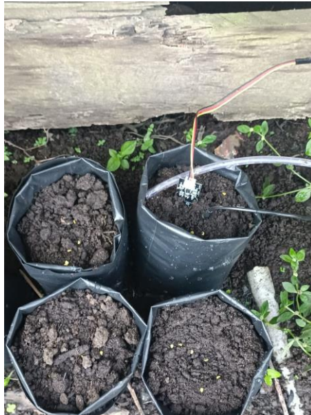
Gambar 11 Pengimplementasian pada Sensor Soil Moisture dan DS1820
